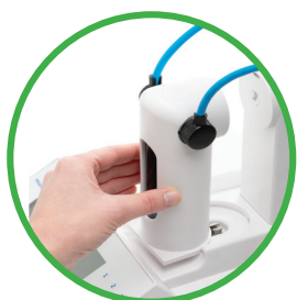
Clip-Lock: sustitución rápida de la bureta.
